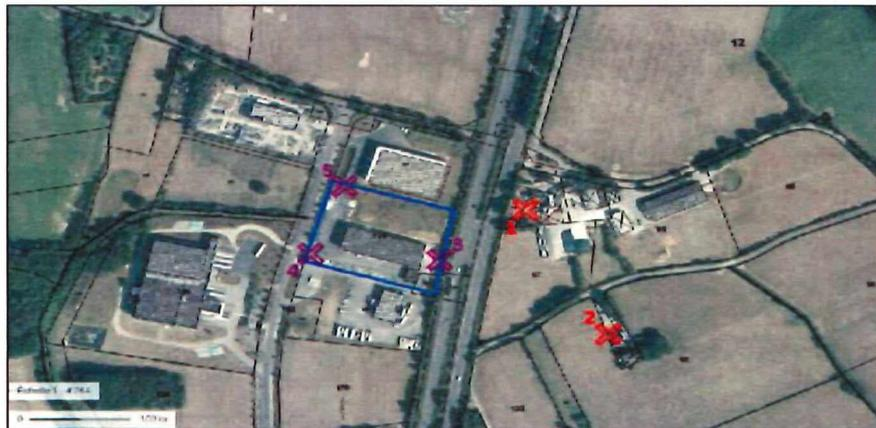
En l'absence d'activités nocturnes, seuls les contrôles diurnes ont été réalisés. Les niveaux sonores mesurés en limite de propriété et les émergences calculées aux 2 zones à émergence réglementée (ZER) les plus proches étaient conformes aux seuils imposés par l'arrêté du 23 janvier 1997 relatif à la limitation des bruits émis dans l'environnement par les ICPE. Il convient par ailleurs de noter que les niveaux des émergences sur les ZER 1 et 2 sont nuls.
